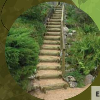
**Escalier:** Aménagement de la pente de la butte pour faciliter l'accès. Modelage du profil existant pour former des marches dans le terrain, pose de rondins de bois si besoin de maintenir la terre.
